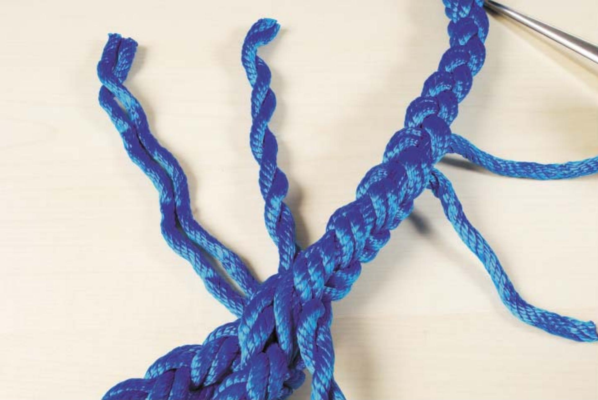
Faites au minimum 4 passages avec 1 x 2 torons autour d' 1 x 2 torons. Pour le dernier passage ne prendre qu'un seul toron pour effiler l'épissure.
