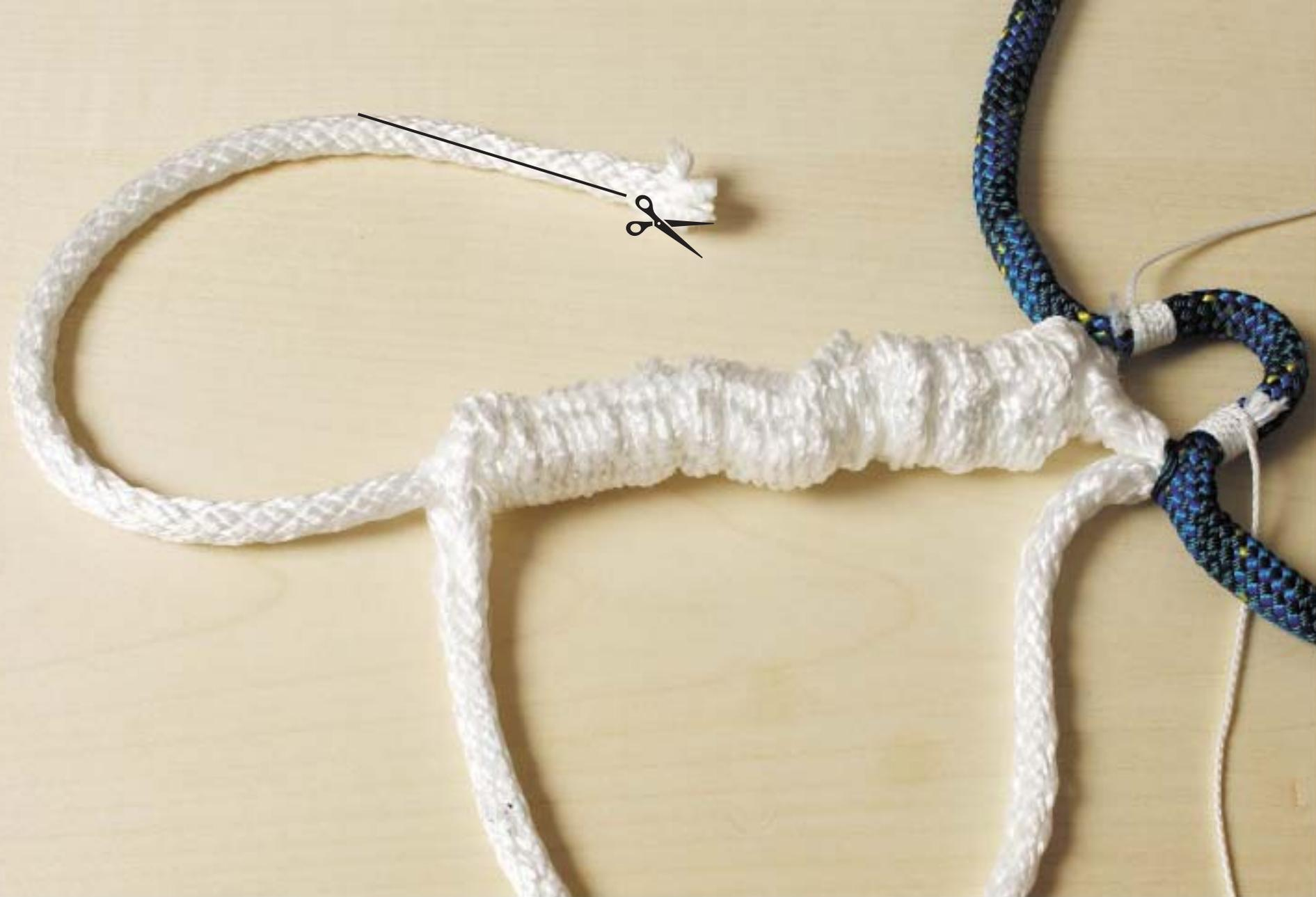
Dégraissez en réduisant le nombre de fils constituant l'âme sur 5 cm.
