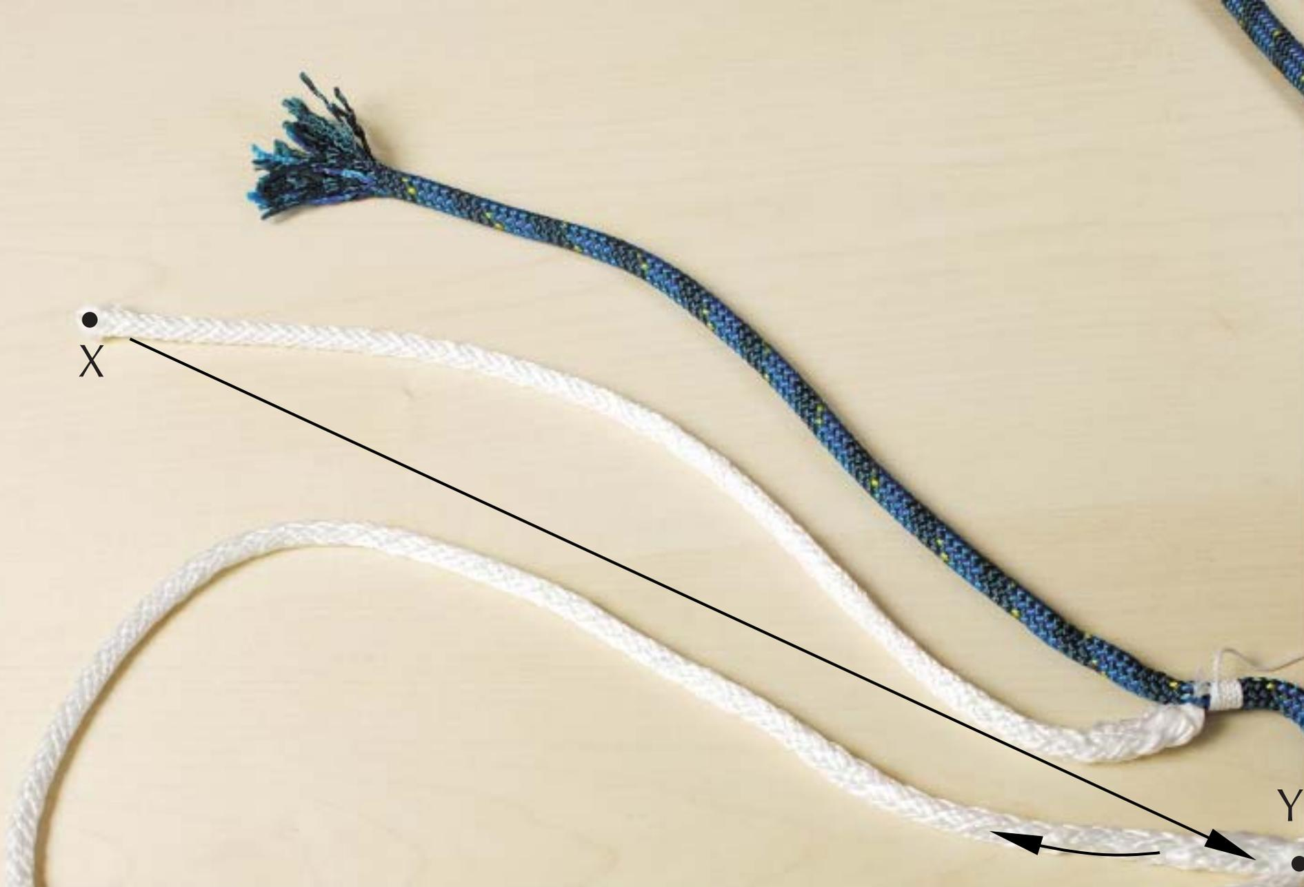
A l'aide de l'aiguille, enfilez l'extrémité X dans la boucle d'âme au point Y qui est bloqué par la surliure.
