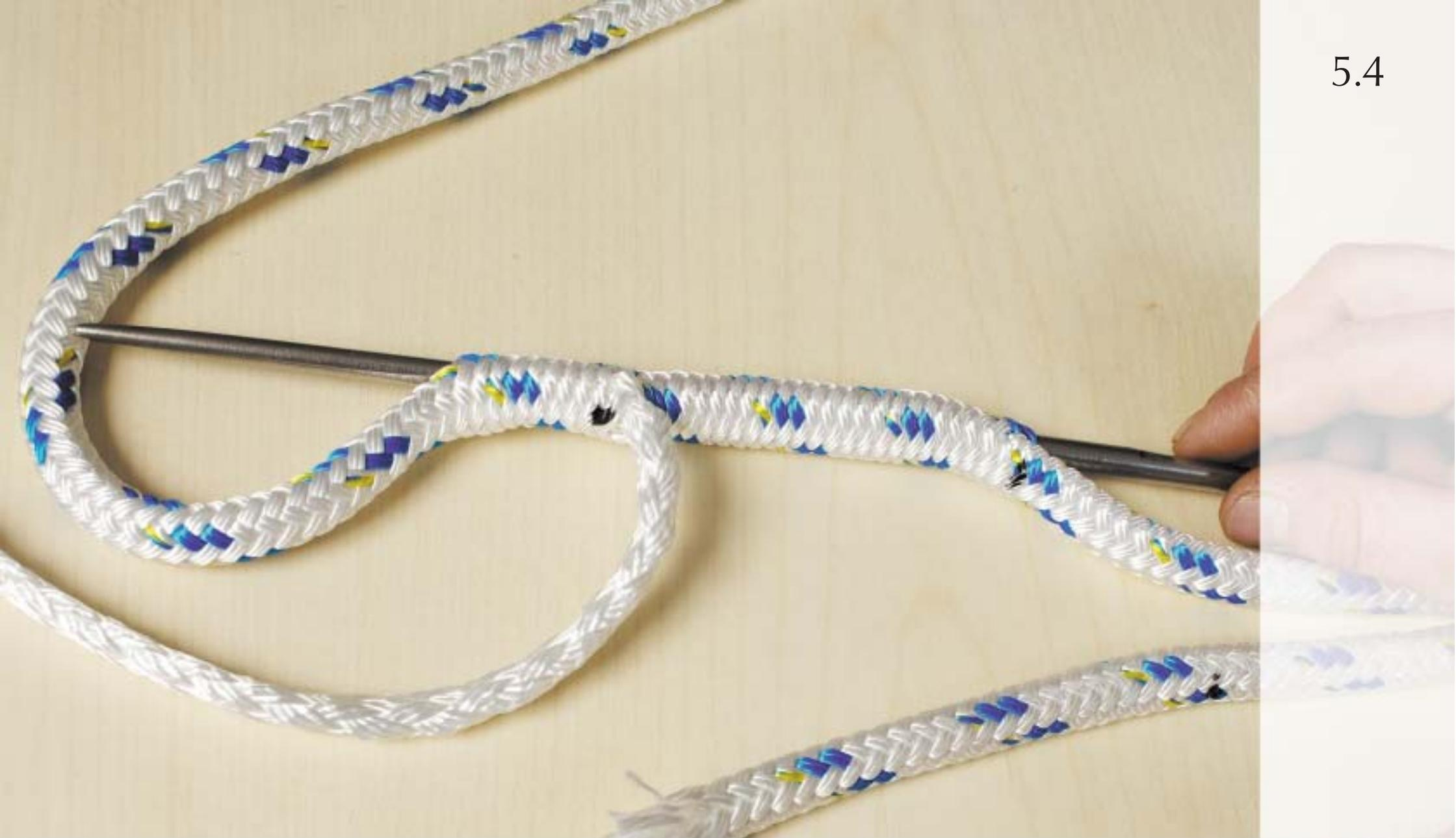
Fixez une gaine dans l'aiguille, et rentrez au point 15 cm de l'autre extrémité. Ressortez au point 30 cm, ou mieux: 2cm après ce point.
