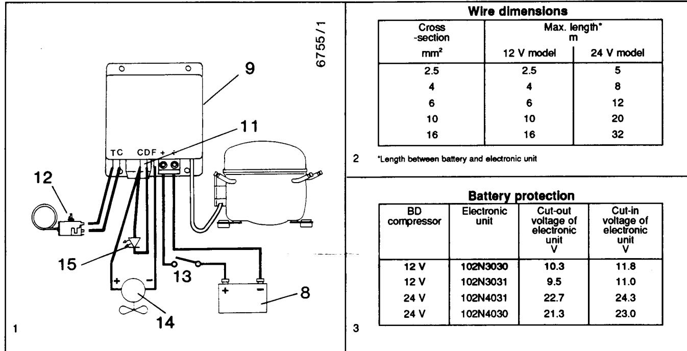
Wenn der Anlauf- oder Überlastungsschutz betätigt wird, tritt der Kompressor in einen Zyklus ein, in dem er in Abständen von 30-40 Sekunden anzulaufen versucht.
