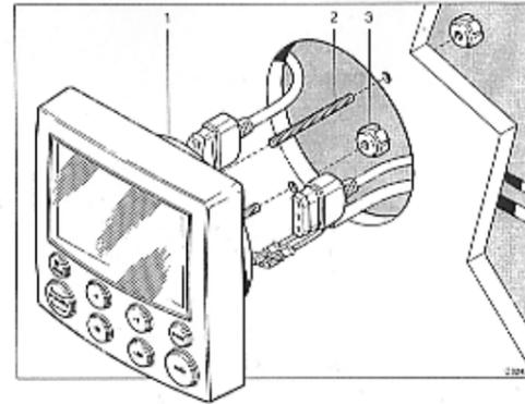
Remarque : laissez toujours un espace de 6mm entre 2 cadrans pour permettre la pose du capot de protection.
