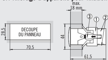
Pour fixer les contrôleurs situer les ancrages 1 sur les rails 2 dans la position de la figure. Déplacer l'ancrege dans le sens de la flèche. En appuyant sur l'ongle 3 on peut déplacer l'ancrege dans le sens contraire de la flèche.
